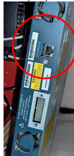
Εικόνα 11.8 – Σύνδεση στην console port
